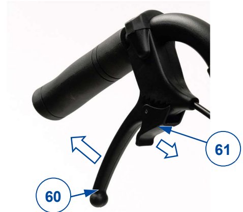
Ilustracja 5 Obsługa hamulców bębnowych
